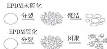
图4 未硫化和硫化 EPDM 橡胶颗粒加工过程示意图
